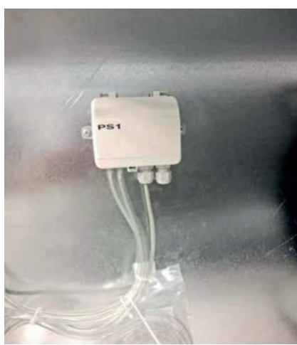
Slika 50: Tlačni senzor z dvema diferenčnima senzorjema tlaka. Uporablja se za merjenje tlaka v kanalu in zračnega pretoka dovodnih in odvodnih ventilatorjev.
