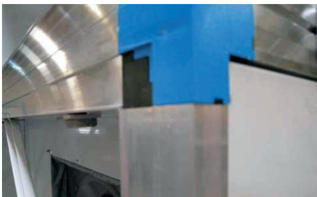
Slika 14: Za povezavo sekcij z aluminijastimi profili na stične čelne površine (okvir ohišja) namestite samolepilni tesnilni trak iz EPDM gume, dimenzij 20 x 8 mm (trak je priložen k napravi).
