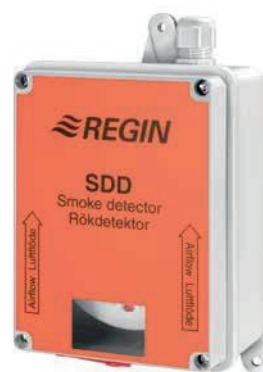
Slika 56: Detektor dima. Deluje kot optični detektor in ima vgrajen relejski vmesnik za alarm. V primeru aktivacije dimnega detektorja se naprava ustavi, kot v primeru požara.
